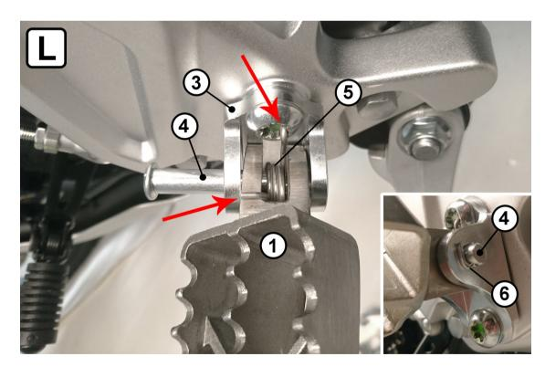
Die Fußrasten (1) bzw. (2) in Position bringen. Die Feder (5) wie gezeigt einlegen und beides mit dem Bolzen (4) fixieren.
