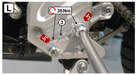
Die originalen Fußrasten inkl. Halter demontieren und die *KEDO*-Fußrastenhalter (3), wie gezeigt, mit den Originalschrauben befestigen.
